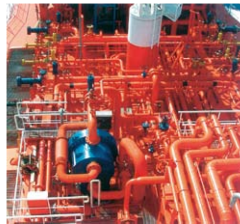
■LPGカーゴヒーター4800kW(LPG船)
